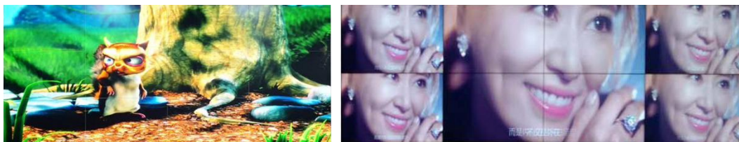
0mm 拼缝拼接（左）与 1.8mm 拼接（右） 实拍对比图
